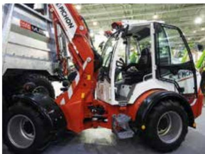
Le nouveau chargeur proposé par la société Pichon est doté d'un moteur 4 cylindres Deutz Tier 4 stage IIIB qui développe 75 ch, d'une transmission hydrostatique à 2 gammes de vitesses et passage automatique.
