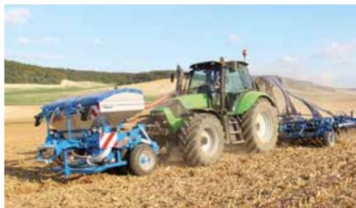
Destiné aux tracteurs de 160 à 200 ch, la société Carré élargit sa gamme de semoirs à dents semeuses avec le **Penterra-S** qui combine une trémie avant Octopus à la version semis du Penterra. Il se décline en 3 modèles de 4, 5 ou 6 m de largeur de travail. La trémie frontale avant est disponible en 1400 ou 1800 l avec un doseur universel pouvant semer tout type de semences sans changer de cannelures.
