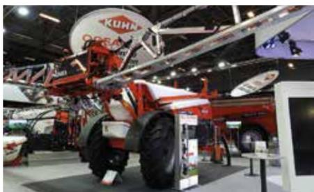
Les pulvérisateurs traînés Océanis seconde génération 5002, 5602, 6502, 7702, adoptent une capacité de cuve de 5000, 6000, 6500 et 7000 l. Ils reçoivent un nouveau système de pulvérisation à porte buse électrique dénommé Multispray qui permet la sélection de buses depuis la cabine, le choix automatique de la buse en fonction de la vitesse d'avancement et la coupure automatique par GPS de chaque buse.
