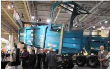
Pour transporter en toute sécurité plus de volume, les bennes **RollSpeed 7136** et **7845** adoptent une version HD (photo) avec un profil de caisse monobloc en acier HLE d'1,80 m qui évite le montage et le démontage de rehausses. Elles bénéficient d'un nouveau boîtier électronique 5 fonctions pour piloter les fonctions de base (bennage, porte, flèche, suiveur, report de charge).
