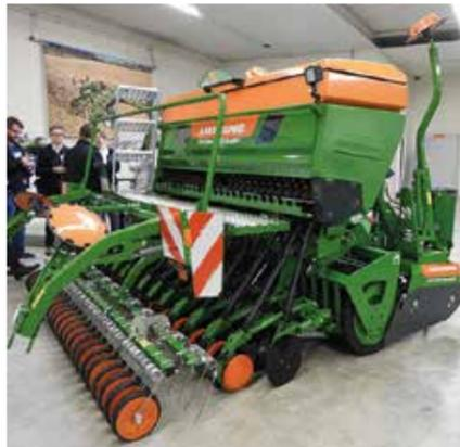
Conçu pour les exploitations de grandes cultures, le combiné de semis Cataya se compose d'un semoir compact Cataya 3000 Super associé à une herse rotative KE 3001 ou à un cultivateur rotatif Cultimix KG ou KX 3001. Il est équipé d'une trémie d'une capacité de 830 l à 1270 l intégrant un niveau de remplissage qui coulisse en continu sur un rail de guidage.
