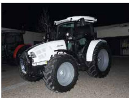
Destiné aux vergers, vignobles et pépinières, le nouveau tracteur **Spire F Target** de Lamborghini se distingue par une couleur blanche et des lignes arrondies. Il est pourvu d'un moteur FarMotion stage 3B (Tier 4i) de 3 ou 4 cylindres avec système d'injection Common Rail et un dispositif de traitement des gaz d'échappement DOC.
