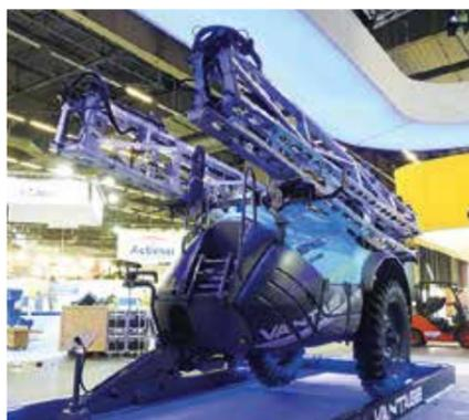
Le nouveau pulvérisateur tracté de Berthoud, le **Vantage**, se démarque des autres modèles par son style original (centre de gravité bas, proportions compactes) et sa couleur dark, tout en reprenant les fondamentaux de la marque : suspension d'essieu Actiflex II, pompe Omega, mise en œuvre Dualmatic et panneau Berlogic.
