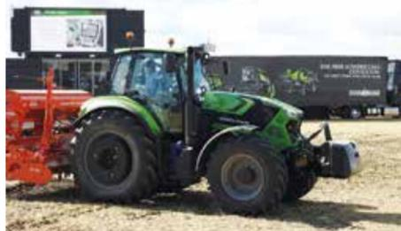
La gamme des tracteurs **série 6** comprend 6 modèles (6155, 6165, 6175, 6185, 6205, 6215) pourvus du moteur Deutz 6,1 l de cylindrée conforme à la norme Tier4 final, avec vanne EGR, système d'échappement des gaz à technologie SCR et filtre à particules passif. Un nouveau système de refroidissement en aluminium et un ventilateur visco-coupleur favorisent un rayonnement thermique supérieur.
