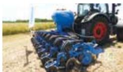
Le semoir monograine de précision **Azurit** doté du système de positionnement de graines DeltaRow fait son entrée en 2017. Le concept répartit les graines en quinconces sur deux rangs espacés de 12,5 cm l'un de l'autre permettant à la plante de disposer de 70 % d'espace supplémentaire pour s'alimenter en eau et nutriments. Ce matériel capable de travailler à 15 km/h adopte le dispositif de distribution « seed on demand » (graine à la demande), la gestion de tronçons, le jalonnage automatique.
