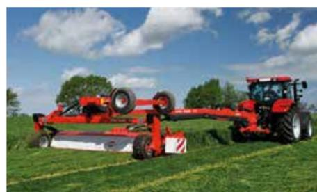
La nouvelle faucheuse à disques traînée GMD 5251 TC à timon central complète par le haut la gamme des faucheuses traînées GMD 2850 à 4050 TL à timon latéral.
