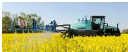
Après les versions Slant Control et Total Control, le système Boom Control (réglage de la hauteur de rampe) accueille une nouvelle version avec la technologie Active Roll. Disponible en option sur les pulvérisateurs Berthoud Ténor et Raptor équipés de rampes de 36 m et plus (Ektar B2, B3, Axiale 36/38, Kondor), l'Active Roll permet de piloter automatiquement la
