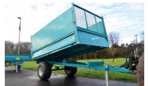
Dédiées aux espaces verts, ces 2 benes de 3 et 4,5 tonnes sont issues d'un partenariat avec le fabricant Albigeois JPM : Rolland fabrique le châssis et JPM la benne.
