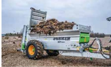
Le constructeur belge étoffe sa gamme d'épandeurs de fumier Siroko avec un modèle d'entrée de gamme, le S4008/8V d'une capacité de 8 m<sup>3</sup>. Développé sur la base du plus petit modèle existant (S4010/9V), il reçoit le même train roulant et la même longueur de caisse (4 m), mais voit sa hauteur de caisse rabaisée de 24 cm pour atteindre 85 cm.
