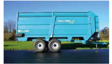
Les distributrices d'aliments DAV, comprenant 2 modèles de 10 et 14 m<sup>3</sup>, s'agrandissent par le haut avec 2 nouveaux modèles (RD 6218 et RD 6222). Le premier possède 2 démêleurs et un volume de 18 m<sup>3</sup>. Celui de 22 m<sup>3</sup> est pourvu de 3 démêleurs. Ces machines sont équipées d'un tapis de fond hydraulique à chaînes marines et de 2 essieux. Leur longueur utile de chargement est 6,20 m pour une largeur intérieure de 1,85 m et une hauteur de côtés de 1,60 m.
