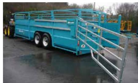
Avec 6 modèles (47, 52, 59, 64, 742, 852) de 4,70 m à 8,50 m cette gamme remplace la précédente gamme V. Ces bétailières bénéficient d'une nouvelle ergonomie pour une meilleure sécurité au travail avec un fond en résine antidérapant et antibruit, une porte arrière autolock, une hauteur de côtés à 1,50 m, une largeur intérieure de 2,30 m et un essieu surbaisseur (breveté Rolland) graissé et suspendu.
