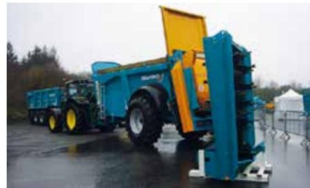
4 nouveaux modèles d'une capacité de 7 à 11 m<sup>3</sup> (RFC 3507, 4008, 4010, 4511) succèdent à la gamme RollTwin. Equipés de deux hérissons verticaux, ils adoptent le cadre d'épandage Rolland ESP (système breveté) et le look des RollForce. Ils ont une longueur compacte de 3,50 m / 4 m et 4,50 m.
