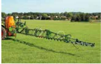
De série, tous les pulvérisateurs Amazone portés, traînés et automoteurs, disposent du suivi de rampe Distance Control à 2 capteurs pour guider la rampe en hauteur et en inclinaison. Pour des conditions plus difficiles de pulvérisation, le constructeur propose, en option sur tous les pulvérisateurs Isobus, le Distance Control Plus, un système de guidage automatique de rampe doté de 4 capteurs. Ces deux équipements sont disponibles sur les rampes Super S et Super L.
