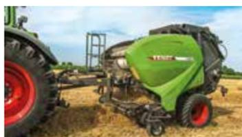
Le constructeur propose une nouvelle gamme de 5 presses à balles rondes à chambre fixe ou variable. Les presses à chambre fixe existent en 3 versions : le modèle d'entrée de gamme sans système de coupe (Fendt 1125 F), le modèle standard Fendt 2125 F et le modèle haut de gamme Fendt 2125 F Profi. Elles sont conçues pour une taille de balle de 1,25 m.
