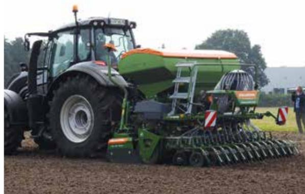
La distribution de la semence est électrique, elle se situe en dessous de la trémie et bénéficie de différentes bobines de dosage.
