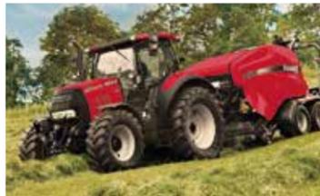
Pour les agriculteurs désireux d'un équipement simple dans la plage de puissance nominale des 140-165 ch, Case IH propose ses tracteurs Puma 140, 150 et 165 X avec un nouvel équipement. Pourvus de la transmission 6 rapports semi-powershift, ces modèles s'identifient sous le nom « Puma X » pour se distinguer des « Puma Multicontroller » (transmission powershift) et des « Puma CVX » (transmission à variation continue).
