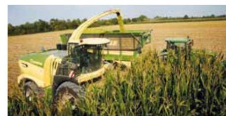
La nouvelle génération d'ensileuses Big X se décline en 3 modèles (Big X 680, 780 et 880). Elle se démarque essentiellement par une nouvelle cabine élévatrice : l'utilisateur peut surélever de 70 cm l'ensemble de la cabine positionnée sur un plateau élévateur hydraulique. Elle possède un multi réservoir qui lui confère de la flexibilité en volume de remplissage : jusqu'à sept produits différents peuvent être sélectionnés (carburant, additif d'ensilage, eau, urée...).
