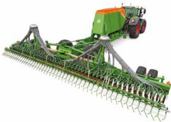
Les nouveaux Citan de 12 et 15 m de largeur de travail (12001-C et 15001-C) se distinguent par leur centre de réglage placé à l'avant de la machine, une nouvelle échelle d'accès en aluminium, une plateforme agrandie pour mieux accéder à la trémie (d'une capacité de 8000 l) et des raccords hydrauliques rangés dans un logement spécifique.
