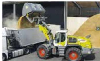
Ces deux chargeuses en haut de gamme se distinguent par une implantation fortement reculée du moteur. Destinées aux entrepreneurs de travaux agricoles, elles sont pourvues de moteurs Liebherr de 195 et 228 ch (aux normes Stage IV). Ces machines ont une charge de basculement de 11,1 T et 12,4 T, une transmission CMatic mécanique-hydraulique à variation continue et un mât de levage en cinématique en Z ou agraire.
