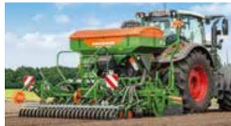
Le semoir pneumatique AD-P 01 Special est proposé en 3 m, 3,50 m et 4 m de largeur de travail. Il comprend 2 gammes au choix avec une trémie de 850 l ou de 1250 l qui peut atteindre 1 100 l ou 1 500 l via une rehausse de 250 l. Deux interlignes sont disponibles en 12,5 cm et 15 cm de profondeur avec des socs WS ou des disques RoTec Control.
