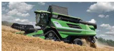
Les moissonneuses-batteuses de la série C9000, lancée en 2014, font peau neuve. Dénommées C9300, elles adoptent des moteurs Mercedes-Benz de 340 et 395 ch, conformes aux normes Stage 4. Elles se déclinent en 4 modèles, 2 à 5 secoueurs (C9305 TS, C9305 TSB) et 2 à 6 secoueurs (C9306 TS, C9306 TSB), pour une largeur de coupe de 5,40 m à 9 m.
