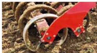
Pour équiper ses déchaumeurs à dents Terrano GX et Cruiser XL, le constructeur allemand propose deux rouleaux polyvalents qui permettent de finaliser le déchaumage superficiel et le travail du sol en profondeur.
