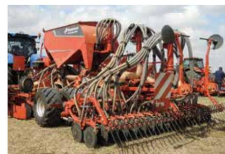
Conçu pour travailler à grande vitesse, l'U-drill est un semoir rapide dont l'élément de semis atteint une force de pénétration de 100 kg. Il est combiné à un tasse-avant (de 800 mm de diamètre), à un cultivateur à disques (de 460 mm de diamètre pour une profondeur de 0 à 13 cm), à un rouleau arrière à pneus (de 900 mm de diamètre) et à une herse de recouvrement à dents en S.
