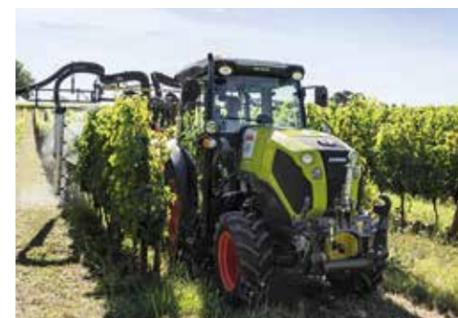
Le tracteur spécialisé Nexos est désormais équipé d'un pont avant suspendu Proactiv quatre roues motrices. La gamme se décline en 14 modèles d'une puissance de 75 à 112 ch avec une largeur hors tout de 1 m pour les VE (version vignes étroites), 1,26 m pour les VL (vignes larges) et 1,45 m pour les F (fruitiers). Cinq boîtes de vitesse sont disponibles avec 4 rapports, 3 gammes, un inverseur mécanique ou Revershift, un doubleur sous charge mécanique ou Twinshift.
