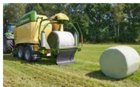
Les combinés de presse Comprima sont pourvus de deux caméras : la première visualise la chambre de pressage pour surveiller le système de liage, la seconde surveille la zone de transfert de balle et la table d'enrubannage. Les images s'affichent sur le nouveau terminal CCI 1200 Krone.
