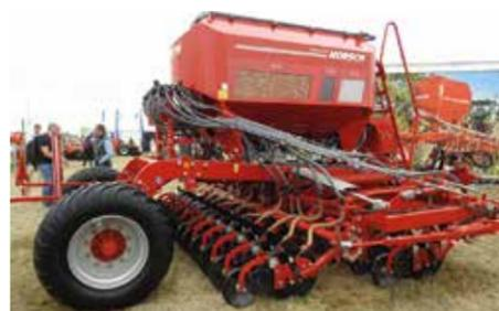
Lancés en 2017, les semoirs monodisque Avatar 3 et 4 SD évoluent. Pour faciliter le chargement, leur trémie a été abaissée de 38 cm pour une hauteur de 2,86 m au lieu de 3,24 m précédemment. L'Avatar dispose à présent de 3 compartiments sous pression avec doseurs distincts de 400, 1 200 et 2 200 l, soit 3 800 l au total.
