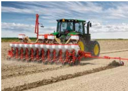
Le semoir monograine Magica 8-12 rangs de Maschio Gaspardo, qui existait jusqu'alors en 6, 7, 8 et 9 rangs, est commercialisé à présent en 8-12 rangs grâce à un châssis à écartement variable hydraulique. Il possède ainsi un inter-rang de 45 à 80 cm. Il peut recevoir une cuve inox de 900 l couplé à un fertilisateur à cuve frontale de 1 100 l. Il est doté d'une largeur au transport de 3,20 m, d'éléments semeurs MTR à entraînement électrique Isotronic gérés depuis la cabine via un terminal isobus.
