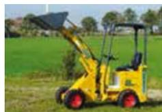
Knikmops a développé une mini-chargeuse électrique, pour l'heure au stade de prototype. Nommée KM130 E, elle a une capacité de
