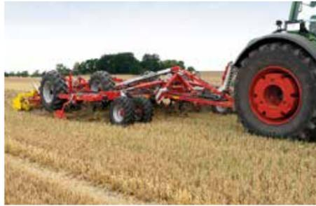
La firme autrichienne met sur le marché une nouvelle gamme de déchaumeurs à dents traînées dénommée Terria. Elle se décline en version à 3 barres (Terria 4030, 5030, 6030) et à 4 barres (Terria 4040, 5040, 6040) avec des largeurs de travail de 4 à 6 m. Sa particularité repose sur des dents réparties de manière symétrique « en miroir » le long de la ligne de traction. Prévus pour un travail de 5 à 35 cm de profondeur, les modèles sont disponibles en sécurité non stop mécanique ou hydraulique.
