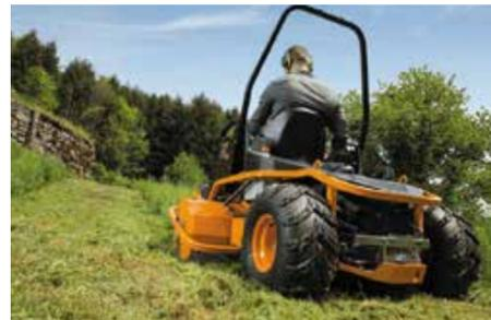
La gamme de tondeuses à fléaux autoportées AS-YAK de AS-Motor s'élargira au printemps 2021 avec deux nouveaux modèles conçus pour l'entretien des terrains difficiles. Le premier dénommé AS 1040 YAK 4WD XL est pourvu de pneus larges et d'une garde au sol augmentée de 30 mm. Quant à l'AS 1020 YAK 2WD, il représente une alternative aux tondeuses rotatives 2 roues motrices conventionnelles pour herbes hautes.
