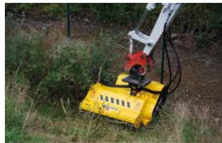
Rabaud élargit sa gamme de broyeurs forestiers Xylor avec des versions sur tracteur ou sur pelle. Celles sur tracteur se déclinent en 4 modèles à marteaux fixes pour des tracteurs de 80 à 300 ch avec une largeur de 2 m ou 2,20 m et 4 modèles à marteaux mobiles pour des tracteurs d'une puissance de 80 à 125 ch.
